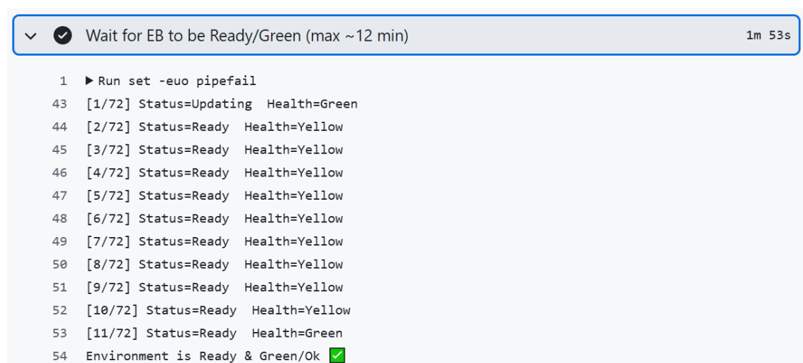
15. ábra A GitHub Actions pipeline várakozása az Elastic Beanstalk „Green/Ok” állapotára (Forrás: saját szerkesztés)
